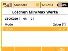
2. Hier im Beispiel: Der Sa Schalter wurde zur Löschung der Minimum/Maximum Werte der Central Box200 ausgewählt. Für die Löschung wird einfach der gewählte Schalter betätigt.
